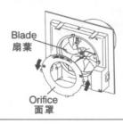
**3** Wash and clean the louver, the orifice 清洗百葉窗、面罩。
